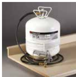
3M™ Postforming 94 CA Cilinderlijmspray is een lijm met een laag doordrukeffect die snel droogt om in 1-5 minuten een omvormbare sterkte na aanbrengen te bereiken. Een open tijd van 1-15 minuten biedt flexibiliteit qua montagesnelheid.
