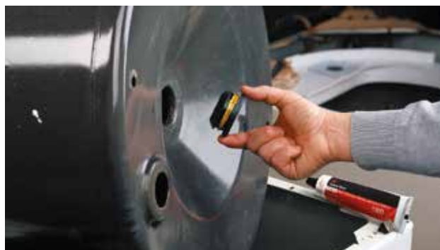
Bij de reparatie van wasmachines zorgt 3M™ Neopreen Hoogwaardige Rubber- en Pakkinglijm 1300 voor directe hechtsterkte en afdichting van de ronde ringafdichting van de buitenkuip.
